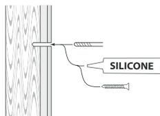
Vid montering på regelvägg på ett avstånd av 1 m från badkar eller dusch måste väggen alltid förstärkas. Alla skruvfästningar skall ske i massiv konstruktion, t.ex. betong, i reglar eller särskild konstruktionsdetalj. Skruvfästning får inte göras enbart i golv-, eller väggskiva. Krav på tätning gäller både i våtzone 1 och 2. Material för tätning ska fästa mot underlaget och vara vattenbeständigt, mögelresistent och åldersbeständigt.
