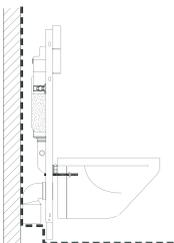
Tätskikt bör finnas på vägg och golv bakom, på sidorna och över fixtur och cistern. (Den streckade linjen). Spolcistern som byggs in i vägg skall placeras i utrymme med dränering av tillräcklig kapacitet. Dränering skall mynna på en plats där man omedelbart kan upptäcka eventuellt läckage och där utläckande vatten inte direkt orsakar skada. Golvet i det utrymme där spolcisternen monteras bör luta mot dräneringen.
